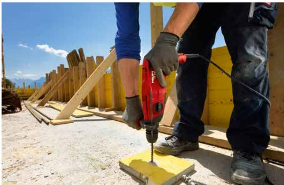
Das Gerät leistet eine Einzelschlagenergie von stattlichen 2,5 J bei 5.160 Schlägen und 1.300 Umdrehungen pro Minute.
